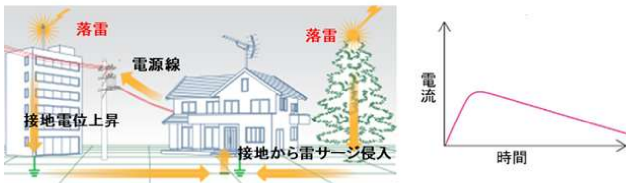
図4 逆流雷 【出典:技術情報 雷サージとは 音羽電機工業株式会社】
