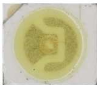
腐食ガス暴露品
