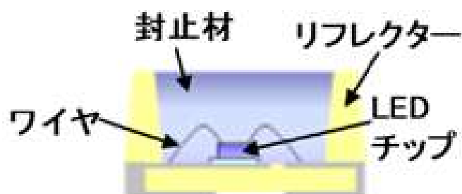
図 3.2 LEDパッケージ構造
