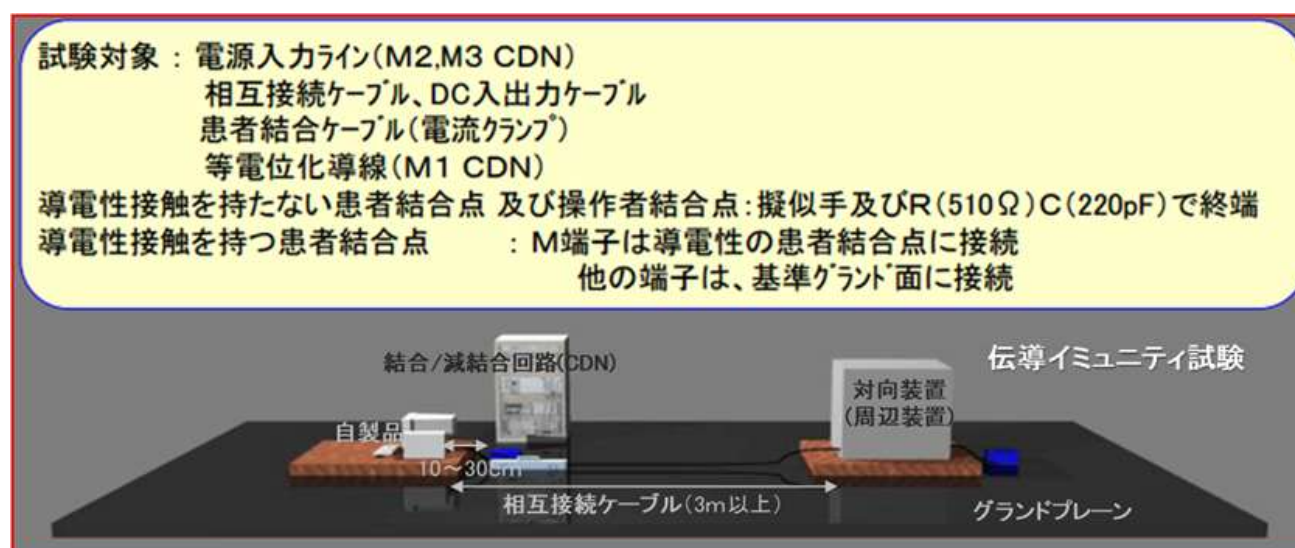
図5 伝導イミュニティ試験構成例
