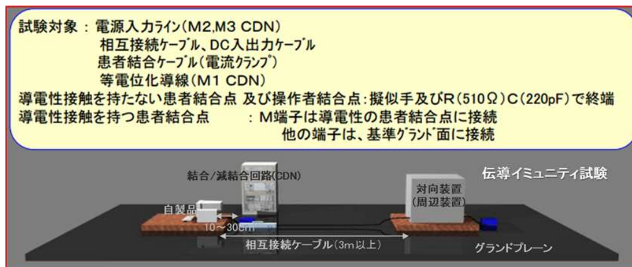
図 5 伝導イミュニティ試験構成例伝導イミュニティ試験構成例
